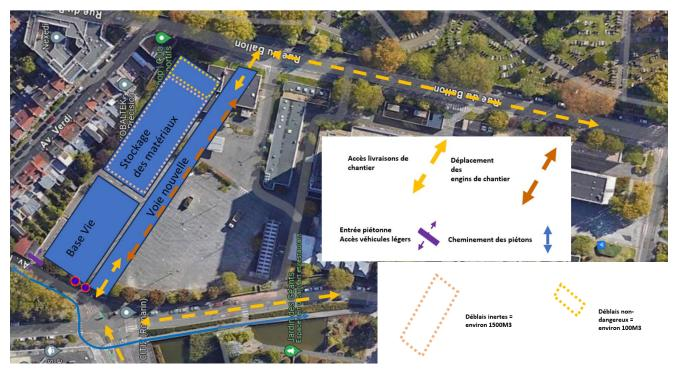
Les matériaux issus du chantier seront stockés sur une hauteur maximale de 2,00m comme ci-dessous. Les poussières de chantier seront traitées par arrosage au moyen d'un camion-citerne afin d'en réduire l'émission.\_\_
